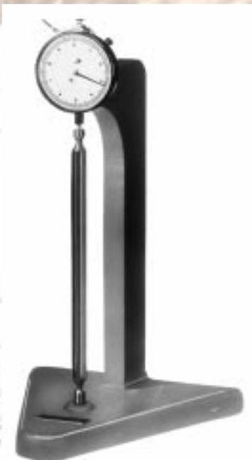
**Equipo de medición de la longitud de las barras de expansión en autoclave**
